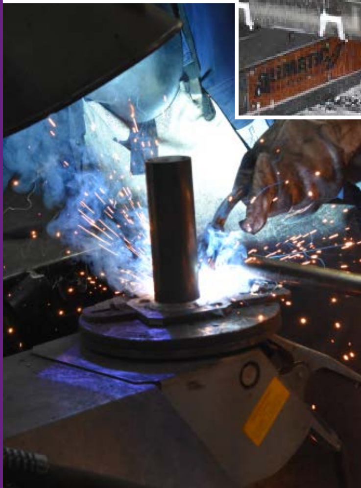
▲ Schweißarbeiten an Sonder-Pfostenträgern
