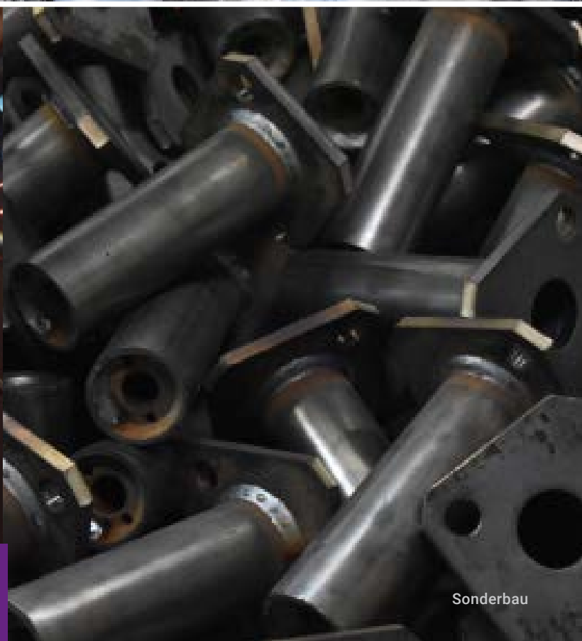
▲ Schweißarbeiten an Sonder-Pfostenträgern
