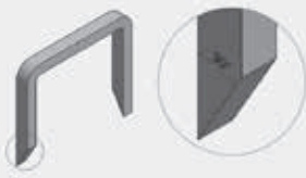
DL-Schnitt Sägeschnitt (Spitze nach links)
